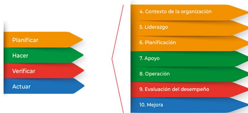
Figura 1. Requisitos de ISO 50001:2018 en base al ciclo de mejora continua. Fuente: Guía de implementación e interpretación de requisitos del estándar ISO 50001:2018.
